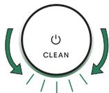
При необходимости опустошения мусоросборника на индикаторном кольце отображается анимированная красная индикация, движущаяся к задней части робота.
