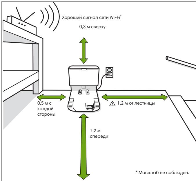
**Примечание.** Не следует устанавливать систему автоматического извлечения мусора Clean Base в месте, в котором она будет подвергаться воздействию прямого солнечного света. Вокруг док-станции не должно быть загромождающих проезд вещей, чтобы робот мог беспрепятственно возвращаться на нее.
