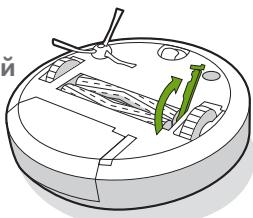
**2** Извлеките валики-скребки из робота. Снимите колпачки с концов валиков-скребков. Удалите скопившийся мусор и волосы из-под колпачков. Установите колпачки щеток на место.
